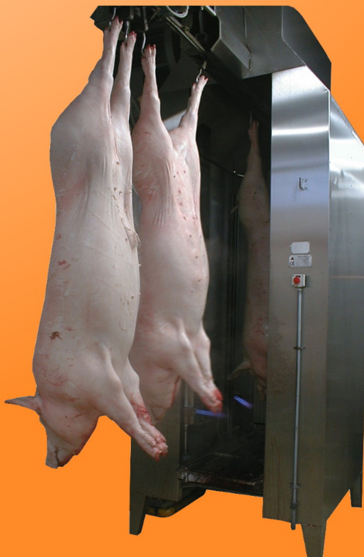
Tunnel di fiammatura e spazzolatura
