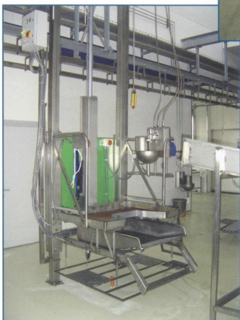
Pedana di eviscerazione con vaschetta per corpi intestinali e scivolo di convogliamento in tripperia
