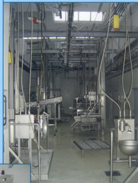
Pedana con foro centrale per la operazione di scuoiatura manuale o semiautomatica con il rullo strappapelle ( optional )
