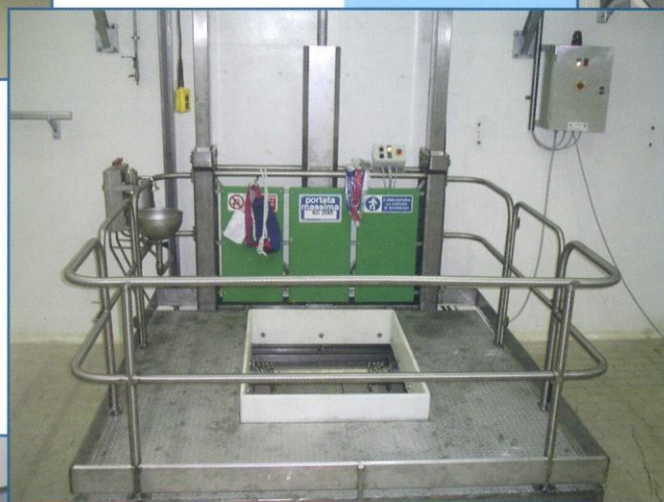
Pedana con foro centrale per la operazione di scuoiatura manuale o semiautomatica con il rullo strappapelle ( optional )
