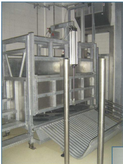
Trappola di abbattimento a funzionamento pneumatico con colla di aggancio al paranco di sollevamento
